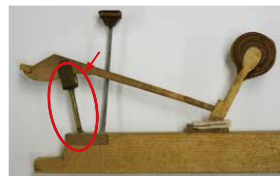
[写真6] オリジナルのハンマーをカプセルに設置した状態 (赤丸の部分がカプセル)
