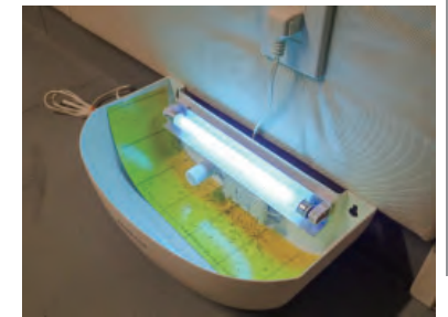
機械室に設置したライトトラップ。黄色い部分が粘着面となっている。
