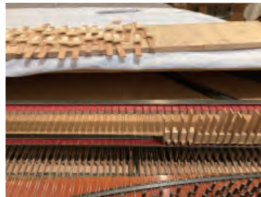
写真14 ダンパー設置
