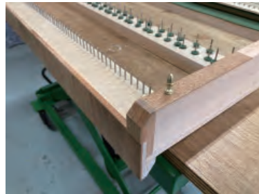
写真11 鍵盤フレーム製作
